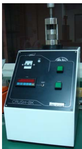
圖2.2 Crush-BK 500PC觸媒破壞強度測試設備
