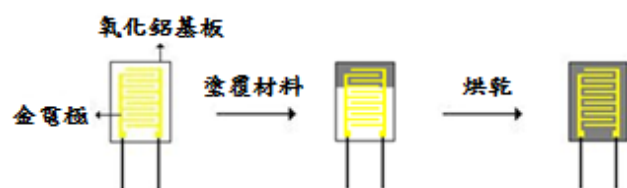
Figure 1: 感測元件製作
