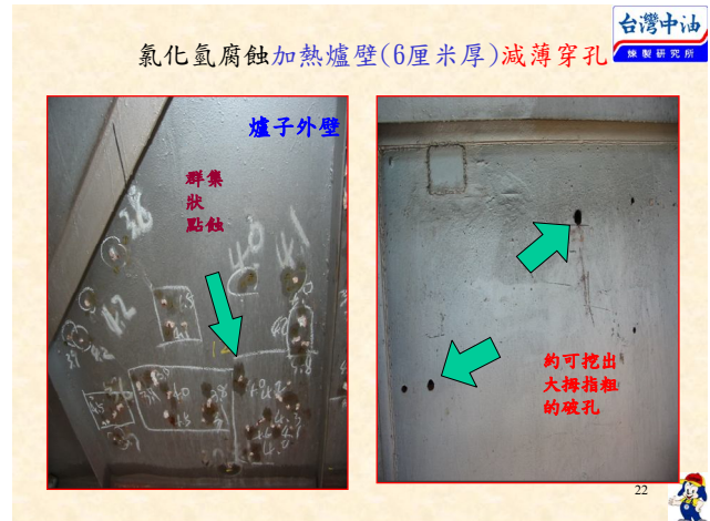
圖 2 氯化氫腐蝕加熱爐壁(6 厘米厚)減薄穿孔
