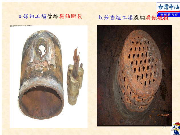
圖 1 微量氯化氫造成管線腐蝕和濾網破損
