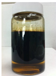
圖5 柳杉木裂解油以Fe-ITRI觸媒加氫脫氧產物外觀(觸媒種類：硫化Fe-ITRI觸媒。加氫脫氧條件：280 °C，110bar，試樣/觸媒比為10/1，反應2小時)
